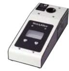
Comprobador de calibración in situ
